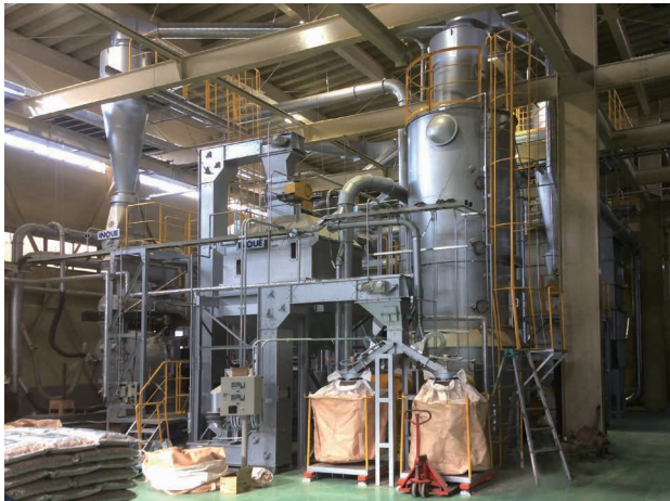
生産能力：3,000kg/h ペレット機：CPM(300kw)
