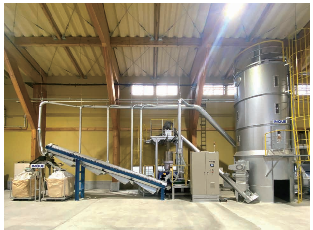
生産能力：350~500kg/h ペレット機：S75(55kw)
