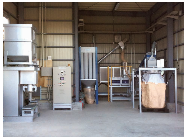
生産能力：50~100kg/h ペレット機：S15(11kw)
