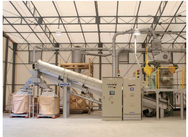
生産能力：1,000kg/h ペレット機：SPM500(55kw×2)
