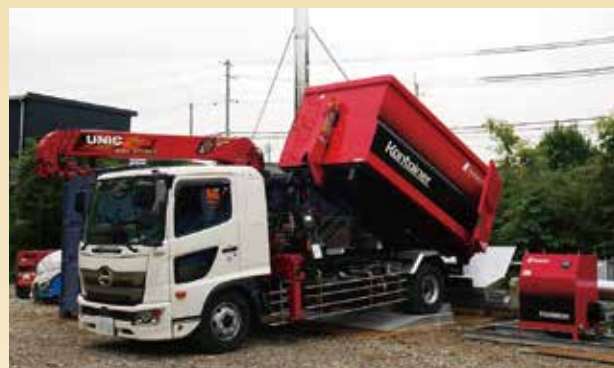
ダンプアップによる水平スクリューへのチップ受入
