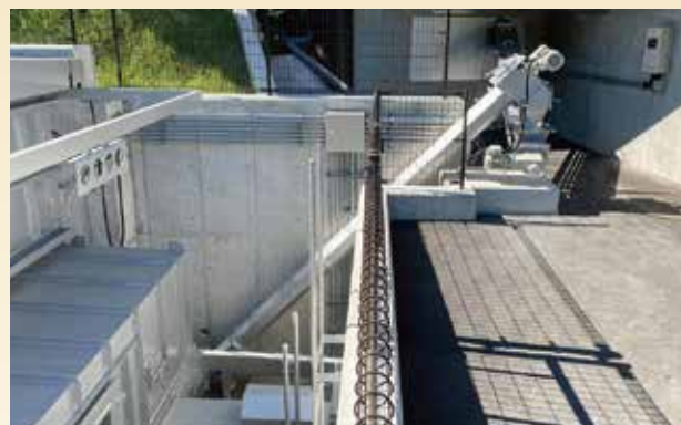
SC20-V 搬送能力：2m 3 /h 傾斜角 45°
