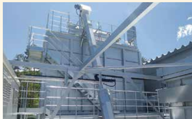
SC40-V 搬送能力：30m 3 /h 傾斜角 73°
