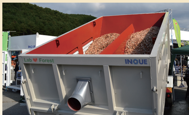
乾燥用温風の給気口と乾燥機構
