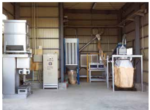
生産能力：50~100kg/h ペレットライン：S15(11kw)
