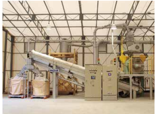
生産能力：1,000kg/h ペレットライン：SPM500(55kw×2)
