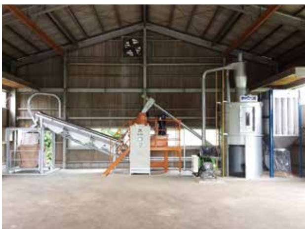
生産能力：150kg/h ペレットライン：PT2242(22kw)
