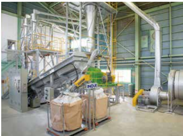
生産能力：500kg/h×2 ペレットライン：S75×2式(55kw×2)
