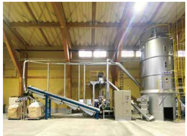
生産能力：350~500kg/h ペレットライン：S75(55kw)
