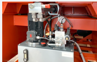
油圧ポンプ/シリンダー ラムをロータの負荷と連動して前進後退高速後退機能付
