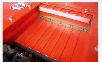
四面セグメントフロア(オプション) 薄い破砕物のラム四面での噛み込み防止
