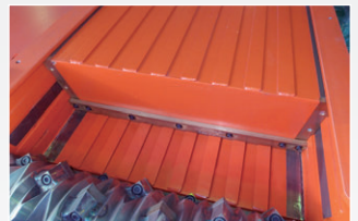
四面セグメントフロア(オプション) 薄い破砕物のラム側面での噛み込み防止
