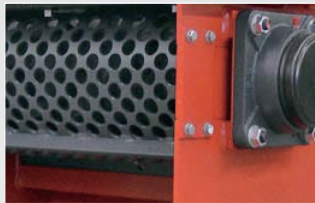
スクリーン 破砕目的・材質・水分で穴径を選択
