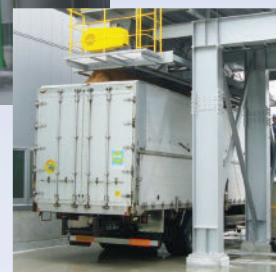
● 均しコンベヤ
