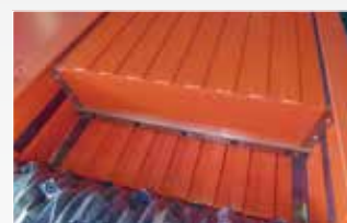
四面セグメントフロア(オプション) 薄い破砕物のラム側面での噛み込み防止
