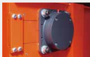
Kベアリング ロータの軸受は密閉型防塵仕様
