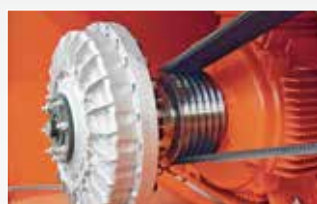
流体継手 ロータ駆動モータ30kW以上に装備
