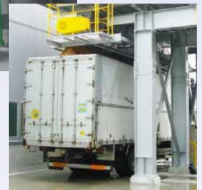
●均しコンベヤ
